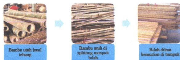
Gambar 1.2 Proses pembuatan bambu lamina
